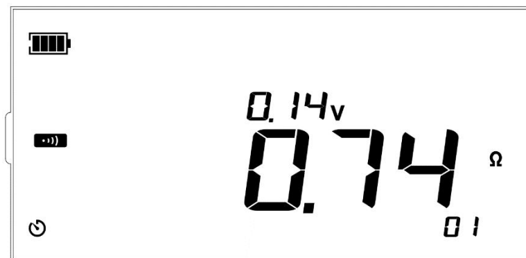
Изображение 13.16 Лабораторные провода замкнуты
