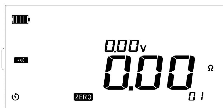
Изображение 13.17 Сопротивление замкнутых лабораторных проводов обнулено
